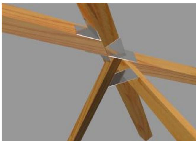
Fig. 7 - Schema 3D piastre di rinforzo nodo
