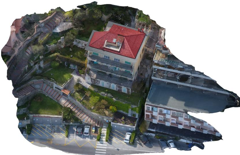
Fig.1 - Rilievo 3D\_Nuvola di punti
