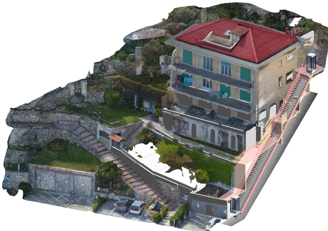
Fig.2 - Sezione 3D sovrapposizione progetto su nuvola di punti stato di fatto rilevato
