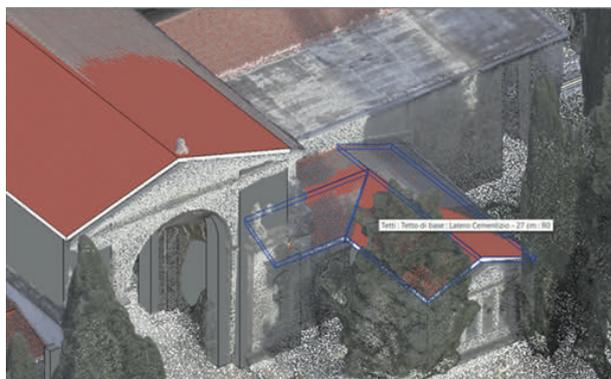
Fig.5 - Ricalco nuvola di punti da drone in Revit
