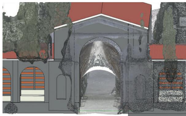
Fig.6 - Sovrapposizione nuvola di punti/modello BIM
