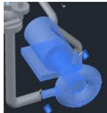
Fig.8 - disallineamento tra pipe e equipments
